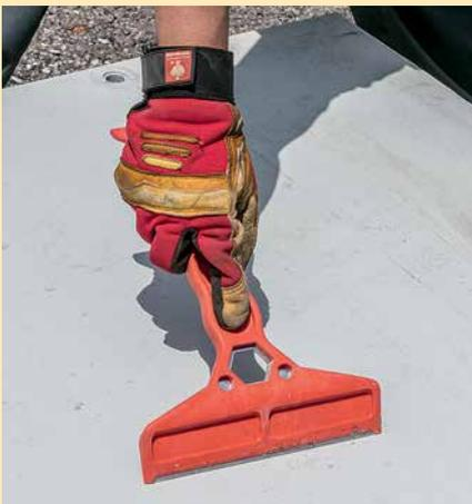
Для очистки обшивки после распалубки следует воспользоваться лопаткой для очистки. Остатки бетона легко удаляются при помощи инструмента.
