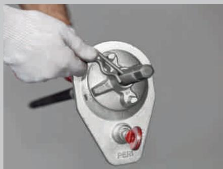
Установите требуемую толщину стены на тяже с помощью шплинта и зафиксируйте контргайкой. На тяже отмечены типовые значения толщины стен.
